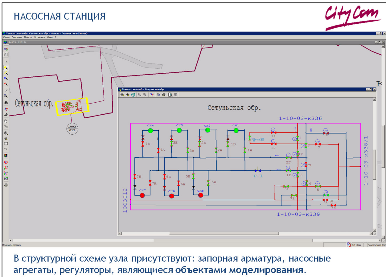
Рисунок 3. Структурная схема сложного узла – насосной станции
