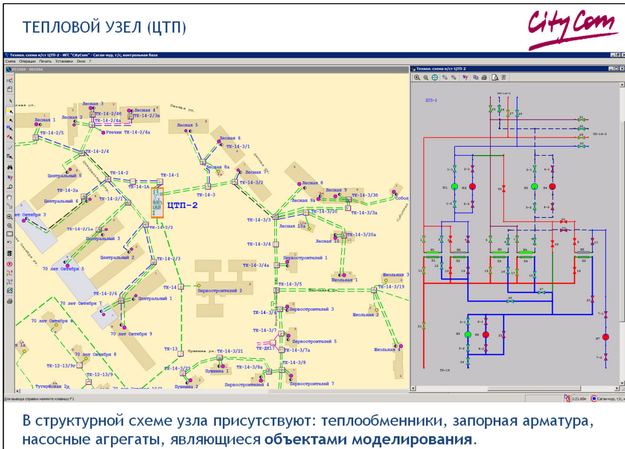
Рисунок 2. Структурная схема сложного узла – теплового узла (ЦТП).
